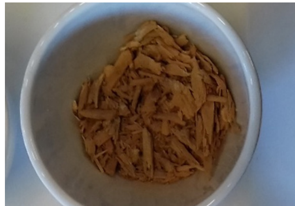
Abb. 4: Teilprobe SH H3 II 2 mm-4 mm nach Glühversuch 550 °C
