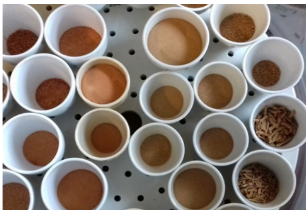
Abb. 5: Teilproben nach Glühversuch, SH H3 II (links 800 °C), SH H3 I (rechts 550 °C)
